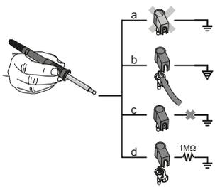
Různým zapojením zdířky s 3,5 mm pomocným kontaktem jsou možné 4 varianty:
