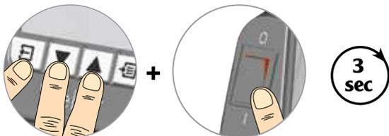
Pri vklopu: Exit, UP in DOWN dokler se ne sproži zvočni signal
