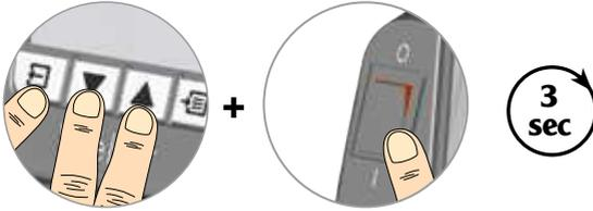
Vid påslagning: Exit, UP och DOWN tills en ton hörs
