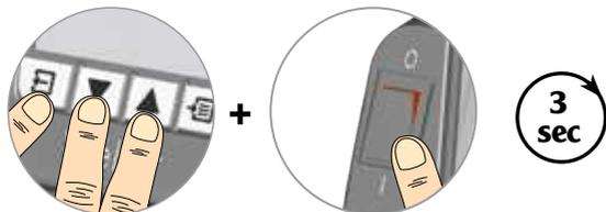
Podczas włączania: Exit, UP i DOWN do usłyszenia sygnału dźwiękowego
