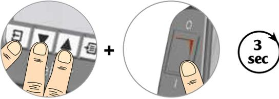
Kod uključivanja: Exit, UP i DOWN dok se oglasi zvučni signal
