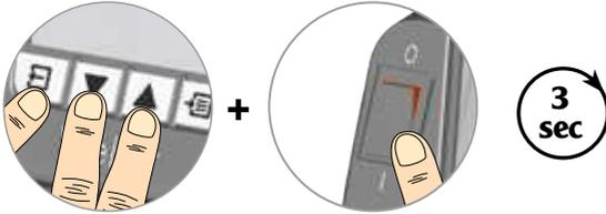
Når apparatet tændes: Exit, UP og DOWN, til der høres et lydsignal
