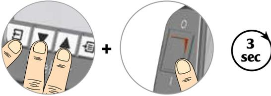
При включване: Exit, UP и DOWN, докато прозвучи звуков сигнал
