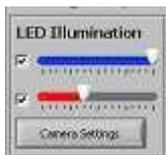
Die Platinen- oder Bauteilbeleuchtung kann hierüber Ein- bzw. Ausgeschaltet und gedimmt werden.
