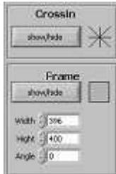
Mit den Schaltflächen Crossing „Show / Hide“ oder Frame „Show / Hide“ wird zur einfacheren Ausrichtung von Bauteilen ein Fadenzug oder ein Rechteck eingeblendet. Größe und Ausrichtung des Rechtecks lassen sich über „Width“, „Height“ und „Angle“ verändern.
