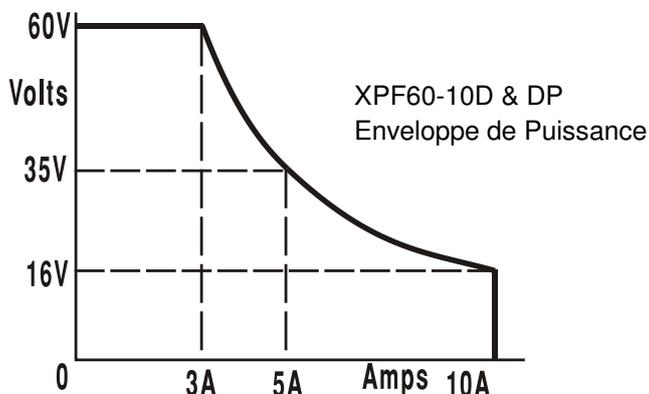
L'enveloppe de puissance est réglée pour donner 60 V/3 A, 35 V/5 A et 16 V/10 A lorsque toutes les conditions d'alimentation sont remplies (les deux sorties sont chargées) ; lorsque les tensions de sortie sont inférieures, l'intensité maximum de 10 A limite la puissance de sortie.
