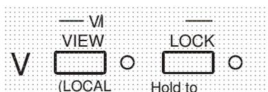
Les limites de tension et d'intensité réglées s'affichent toujours lorsque la sortie est désactivée mais peuvent également être lues lorsque la sortie est activée en appuyant sur la touche VIEW ; le voyant VIEW s'allume lorsqu'on appuie sur la touche VIEW.
