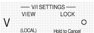
Wenn der Ausgang noch eingeschaltet ist, blinkt **OP on** (Ausgang Ein) zweimal im Display, gefolgt von einer 2-3 Sekunden währenden Blinkanzeige der neuen ‚unverriegelten‘ Einstellungen (erst langsam, dann schneller), bevor die Änderung schließlich durchgeführt wird. Die LOCK Lampe erlischt, wenn die Änderung erfolgt ist.
