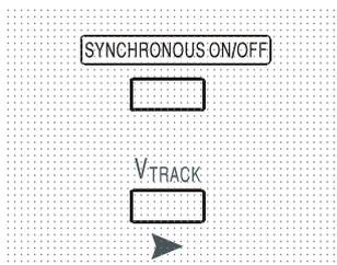
Die Taste SYNCHRONOUS ON/OFF arbeitet zusätzlich zu den einzelnen OUTPUT Schaltern und erlaubt das gleichzeitige Ein- oder Ausschalten beider Ausgänge mit einem einzigen Tastendruck. Da diese Taste beide Ausgänge durch wiederholtes Drücken ein- bzw. ausschaltet, müssen beide Ausgänge den gleichen Zustand besitzen (d. h. Ein oder Aus), bevor die Taste verwendet werden kann. Andernfalls hat ein Drücken dieser Taste keine Wirkung.
