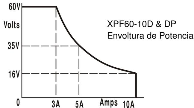
Il power envelope è impostato in modo da erogare 60V / 3A, 35V / 5A e 16V / 10A a qualsiasi condizione di alimentazione (entrambe le uscite sotto carico); a tensioni erogate inferiori, la potenza erogata è limitata alla corrente massima di 10A.
