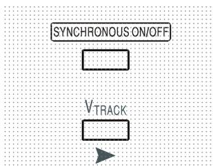
La tecla SYNCHRONOUS ON/OFF (encendido/apagado sincronizado) es una opción adicional a los interruptores OUTPUT individuales, permitiendo conectar o desconectar ambas salidas simultáneamente con una sola pulsación. Puesto que esta tecla enciende o apaga las dos salidas con pulsaciones alternas, es necesario que ambas se encuentren en el mismo estado (encendidas o apagadas) para poder usarla. Su pulsación con una salida encendida y la otra apagada no tendrá efecto alguno.
