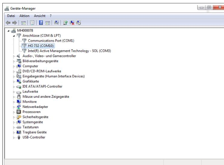
Abb. 2.4: Geräteanzeige unter COM Ports im Geräte-Manager
