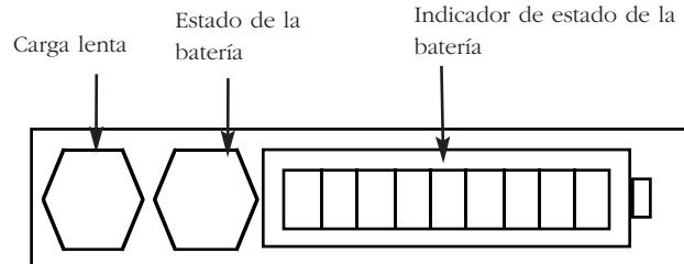
Para conocer la cantidad de carga en su módulo de batería, ya esté conectada a su DLRO o por separado, pulse el botón de estado de la batería. El indicador de estado de la batería encenderá entre 1 y 10 segmentos, lo que significa una carga del 10% y 100% respectivamente. Después de unos segundos, la pantalla se apagará automáticamente.
