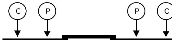
Bei Verwendung von Doppelsonden schienen sicherstellen, dass sich die mit P gekennzeichnete Sonde innenseitig von der mit C gekennzeichneten befindet.
