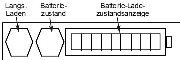
Um den Ladezustand des Batteriemoduls in Erfahrung zu bringen - ob an das DLRO oder davon getrennt - die Taste Batteriezustand drücken. Auf der Batterie-Ladezustandsanzeige leuchten zwischen ein bis zehn Segmente auf, was einen Ladezustand von 10% bis 100% anzeigt. Nach weniger Sekunden verlischt diese Anzeige automatisch.
