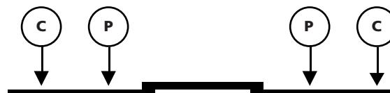
Si se utilizan barras dobles, asegúrese de que el cabezal medidor P está dentro de los cabezales C.
