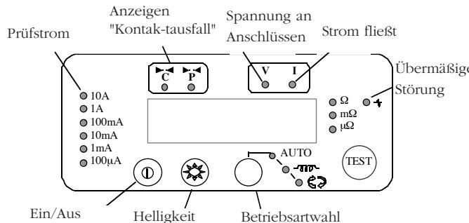
Ein-/Aus-Schalter zum Einschalten des DLRO 10 drücken. Alle Leuchten leuchten auf, die Leuchten 'V' und 'I' blinken, die Softwareversion wird angezeigt und die Leuchte 'W' leuchtet auf. Wurden die Prüfkabel noch nicht am Prüfobjekt angeschlossen, dann leuchten auch die Leuchten 'C' und 'P' auf. Ein-/Aus-Schalter erneut drücken, um das Gerät auszuschalten. Wird das Gerät 5 Minuten lang nicht benutzt, schaltet es sich automatisch aus.
