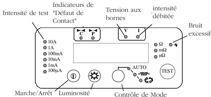
Appuyer sur le bouton Marche/Arrêt pour allumer le DLRO 10. Tous les témoins s'allument, les témoins V et I clignotent, puis la version du logiciel va s'afficher et le témoin W va s'allumer. Si les cordons d'essais n'ont pas été connectés à l'échantillon de test, les témoins 'C' et 'P' vont aussi être allumés. Appuyer de nouveau sur le bouton Marche/Arrêt pour éteindre l'instrument. Si l'instrument n'est pas utilisé pendant 5 minutes, il s'éteint automatiquement.
