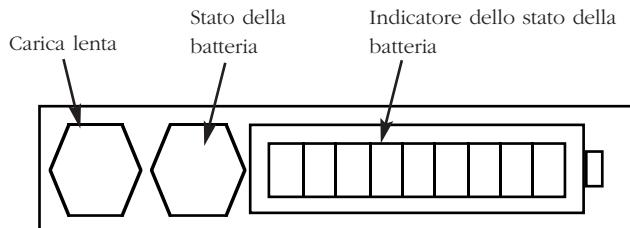
Sulla parte anteriore del modulo della batteria ci sono due pulsanti ed un display LED a 10 segmenti.
