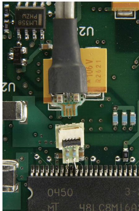
InfiniiMax ZIF tip soldered on board
