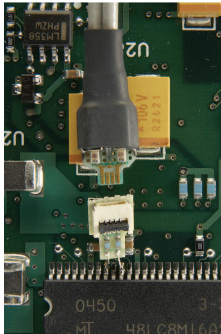
InfiniiMax ZIF tip soldered on board
