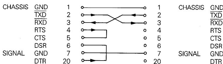
Die Signale RTS, CTS, DSR und DTR haben durch die beiden Brücken 4/5 und 6/20 ständig den Arbeits-Pegel "1" (+ 5 ... + 15 V).
