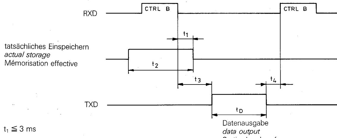
\* Durch eine Linearkorrektur ( $P3 \neq 0$ ) erhöhen sich die Zeiten  $t_2$  und  $t_3$  um je  $\leq 5$  ms
