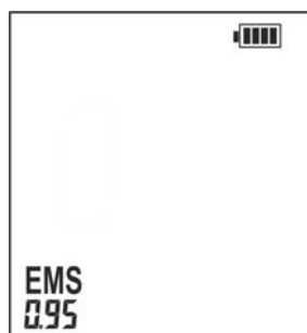
Fig. 8: Réglage de la valeur d'émissivité de la surface
