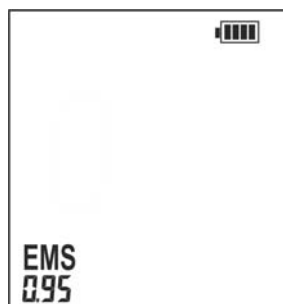
Fig. 8: Impostazione valore di emissività della superficie
