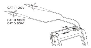
Figure 14. Meter Connections
